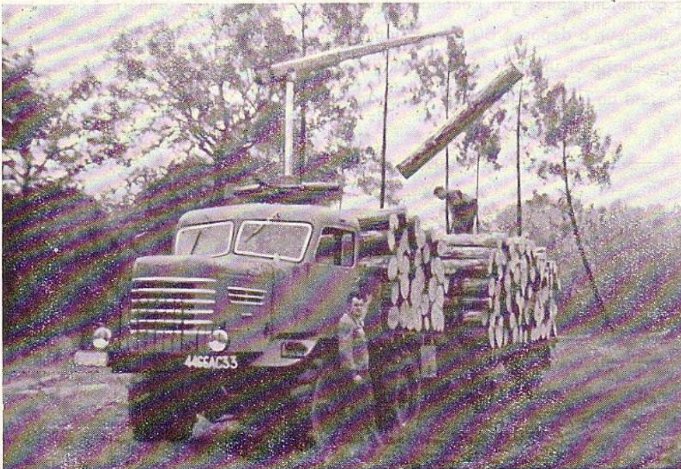
L. D. F. équipé en forestier avec portique arrière pour remplacer le triqueballe
